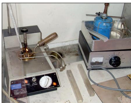
**Labo:** *analyse du degré d'inflammabilité.*
